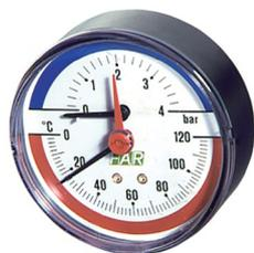
Термоманометры FAR арт. 2550 присоединяется к сети с помощью переходного штуцера с трубной резьбой 1/2". Термоманометр имеет штуцер с трубной резьбой 1/4", который ввинчивается в переходный штуцер 1 (рис. 2). Для герметизации соединений используются стандартные уплотнительные материалы-льняная пряжа, лента ФУМ и т.п.
