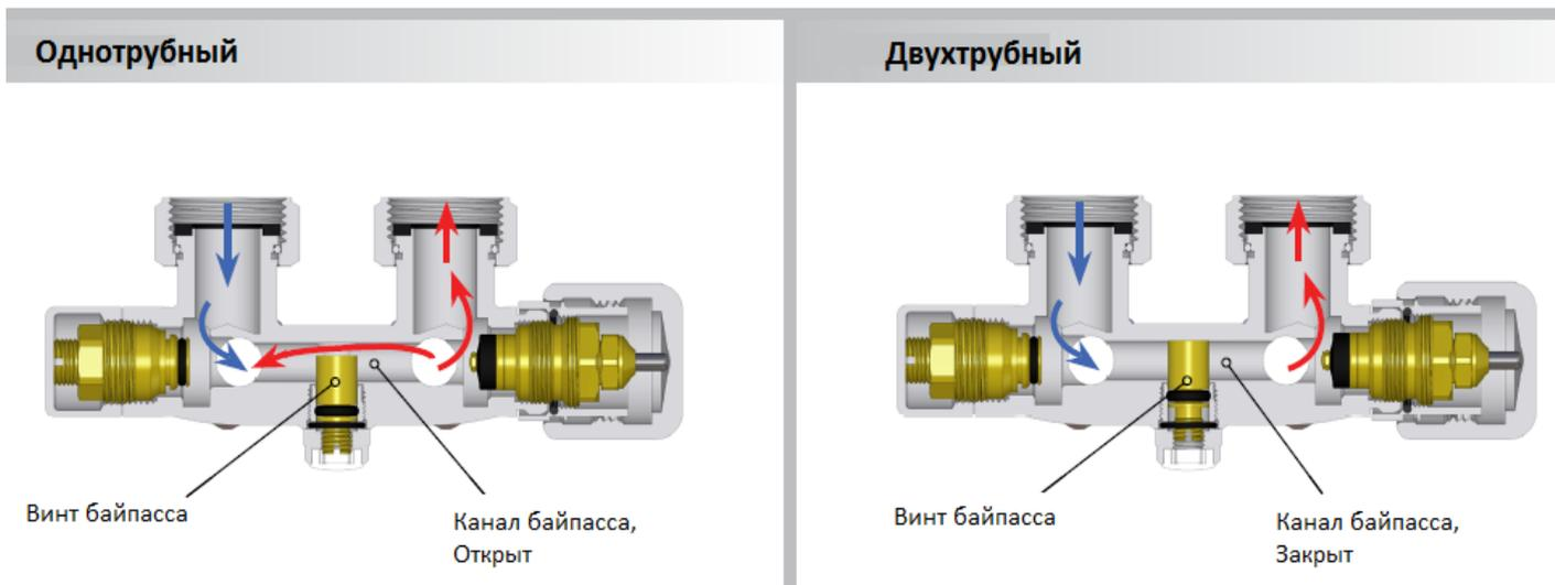
При закрытом канале байпасной линии (двухтрубная система) подключение к трубам отопительной системы должно быть строго: подающий трубопровод должен подключаться к отводу рядом с термостатическим вентилем, обратный – под запорным вентилем. Это требование связано с исключением возможности возникновения шума при установке термоголовки.
