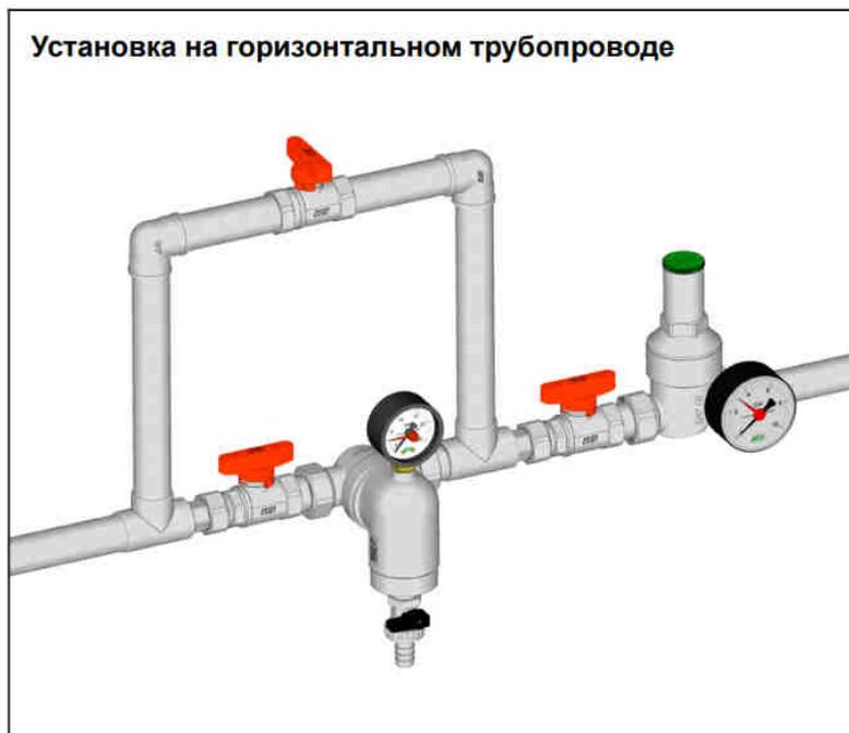
Вода с большой скоростью проходит через фильтр перпендикулярно его фильтрующей сетке. Частицы загрязнений задерживаются фильтрующей сеткой или оседают в отстойную зону, где имеется спускной кран для выпуска осадка. Для нормальной работы фильтр необходимо периодически очищать.
