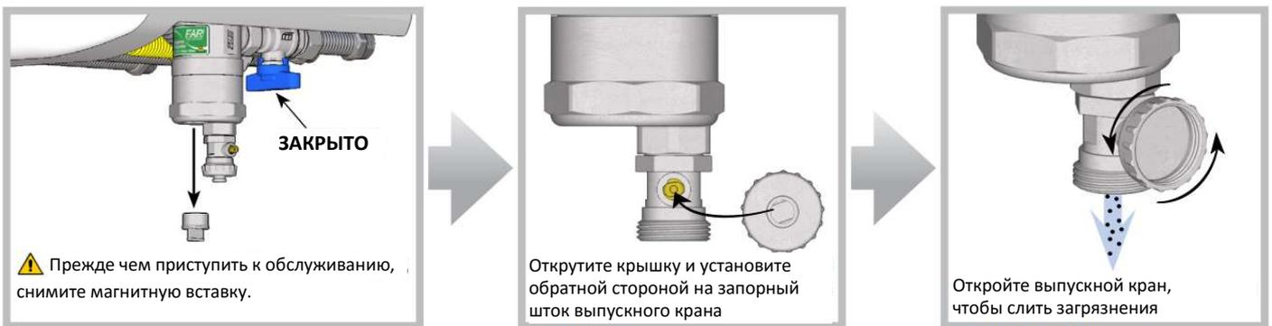
Для полной очистки грязевика нужно использовать трубный или разводной ключ, чтобы открутить нижнюю часть и вынуть картридж для очистки.
