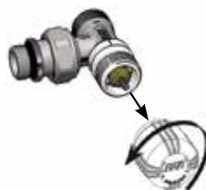
1. Снять белую регулировочную ручку, поворачивая её против часовой стрелки.
